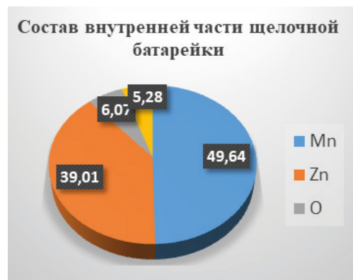
Рисунок 11 – Результат рентгенофлуоресцентного анализа внутренней части щелочной батарейки
