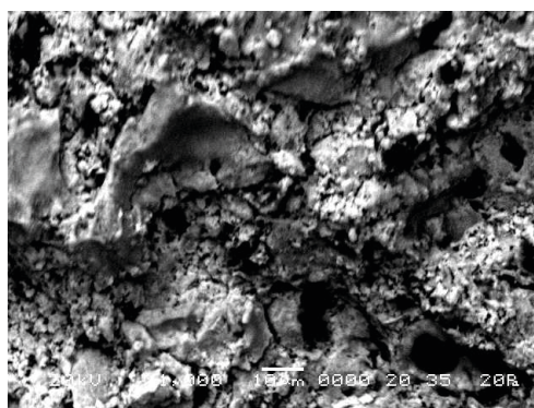
Рисунок 10 – Микроструктура внутренней части щелочной батарейки
