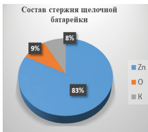
Рисунок 13 – Результат рентгенофлуоресцентного анализа стержня щелочной батарейки
