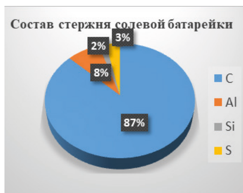
Рисунок 7 – Результат рентгенофлуоресцентного анализа стержня солевой батарейки
