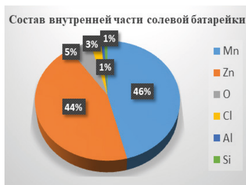
Рисунок 5 – Результат рентгенофлуоресцентного анализа внутренней части солевой батарейки
