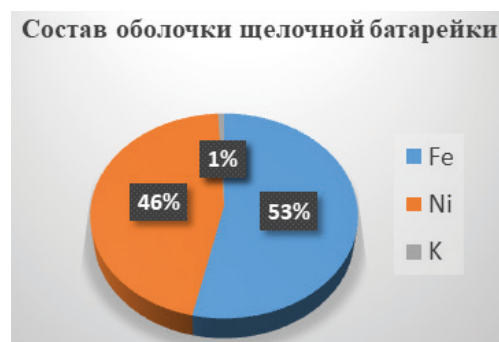
Рисунок 9 – Результат рентгенофлуоресцентного анализа металлической оболочки щелочной батарейки
