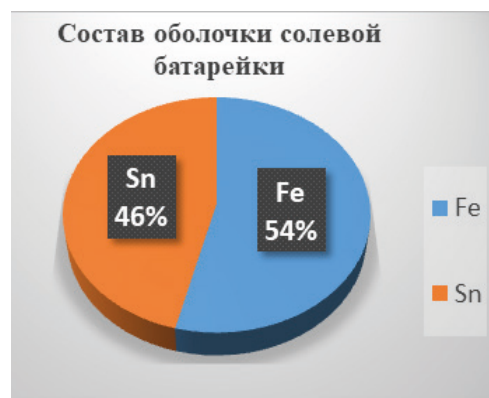
Рисунок 3 – Результат рентгенофлуоресцентного анализа металлической оболочки солевой батарейки
